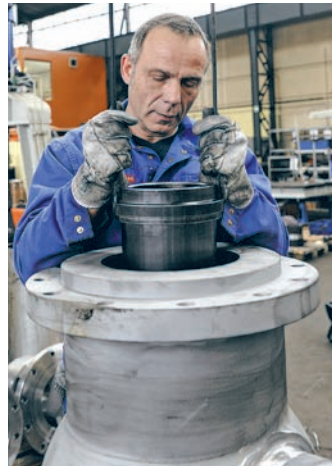
Wichtiger Job: Der Schlosser Klaus Dreßen setzt ein Sicherheitsteil ins Ventil ein.
