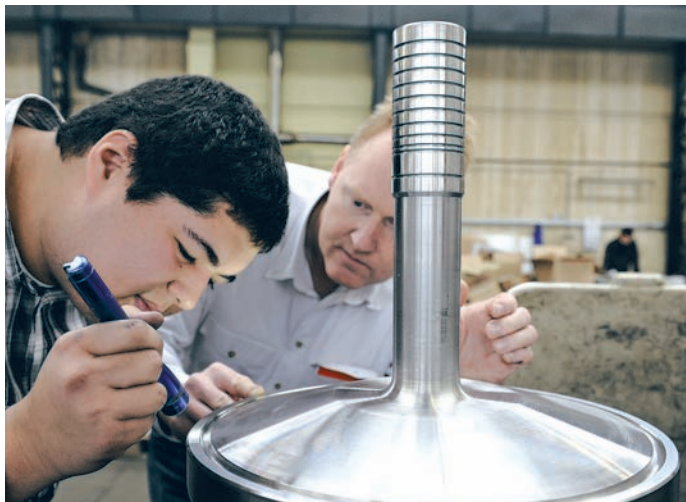
Taschenlampen-Test: Fabian Bohne kontrolliert die Oberfläche eines Kegelsitzes. Der muss im Notfall das Ventil sofort schließen.
