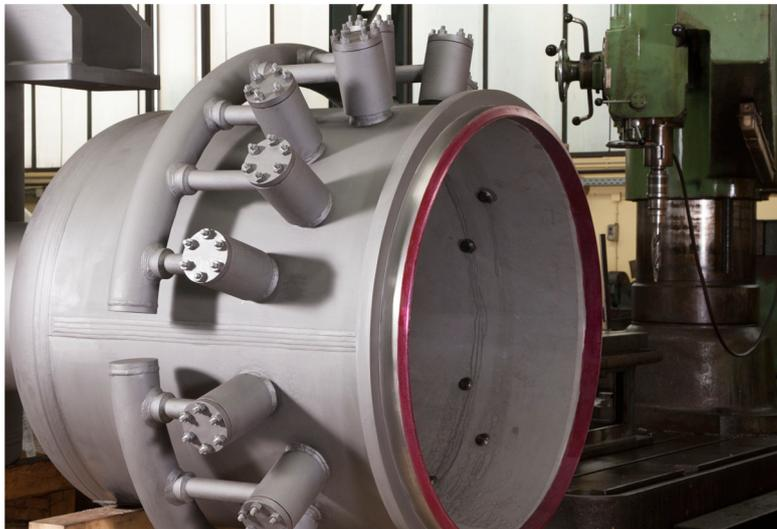
Heißdampfkühler nehmen die Kühlung des Dampfes in der Rohrleitung vor. Die Einspritzung des Kühlwassers erfolgt bei BOMAFA Heißdampfkühlern bevorzugt im Bereich des geringsten Strömungsquerschnitts, mit entsprechend höchsten Dampfgeschwindigkeiten.
