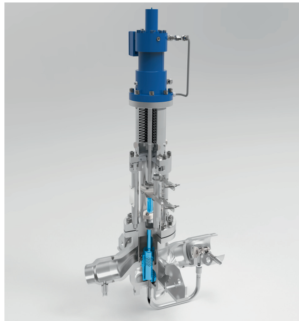
Bild 1: Regelarmatur mit vor Verschleiß geschützter Spindel
